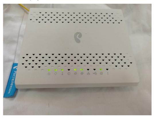
Если устройство до этого уже использовалось, то необходимо сбросить устройство, удерживая кнопку "reset" на задней панели в течении 5х секунд.
